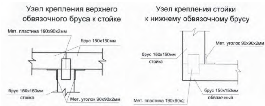
Рис. 4. Узлы крепления обвязочного бруса
