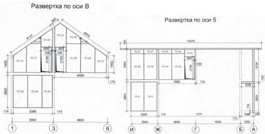
Рис. 5. Схемы развертки монтаж крепления стеновых SIP-панелей
